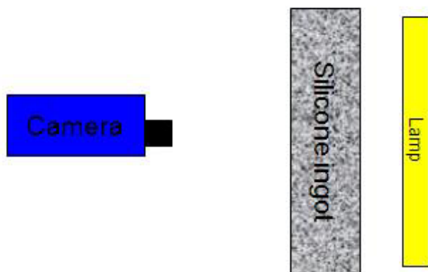
図3 シリコン・インゴットの測定
