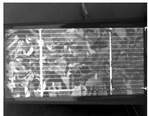
図8ソーラーパネルの赤外線画像
