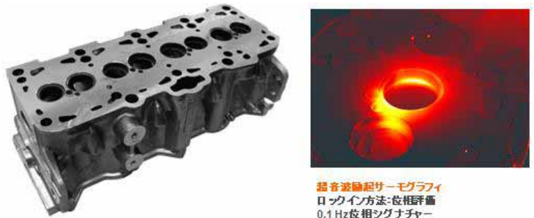
図10 超音波サーモグラフィにバルブシートリング
