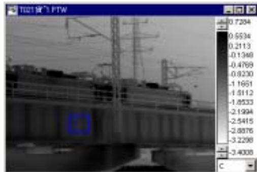
図4 鉄橋を通過する貨物列車の赤外線温度画像
