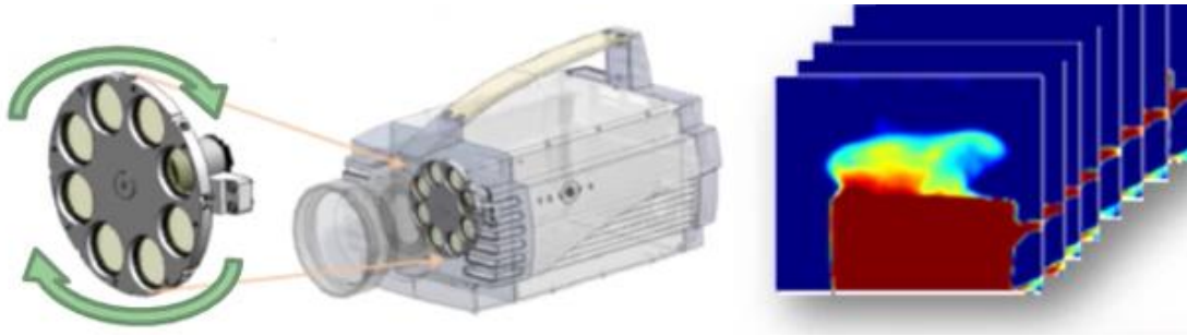
図 10 内臓の回転ホイールにフィルタを付けた赤外線分光カメラ
