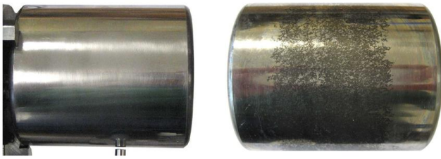
エッチング処理前のワークピース (裸眼の目視観察では検出不可)
