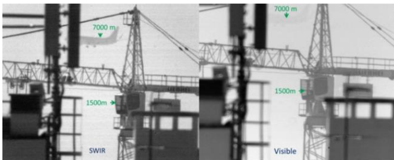
図1 近赤外線カメラと可視カメラの画像の比較
