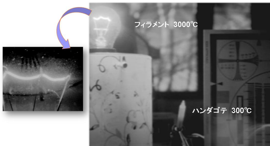
図10 電球フィラメントを含む近赤外線画像
