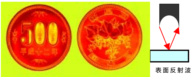
図3 一探触子法による表面反射波画像
